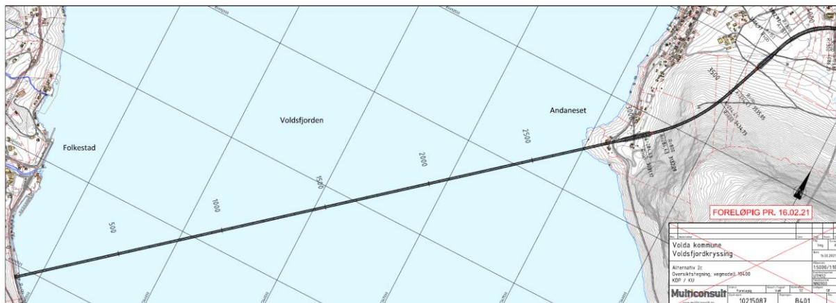
Figur 3-6 Trase for alternativ 2C Flytebru Folkestad – Andaneset, med seglingsløp (høg bru) ved Andaneset (Teikning B401).
