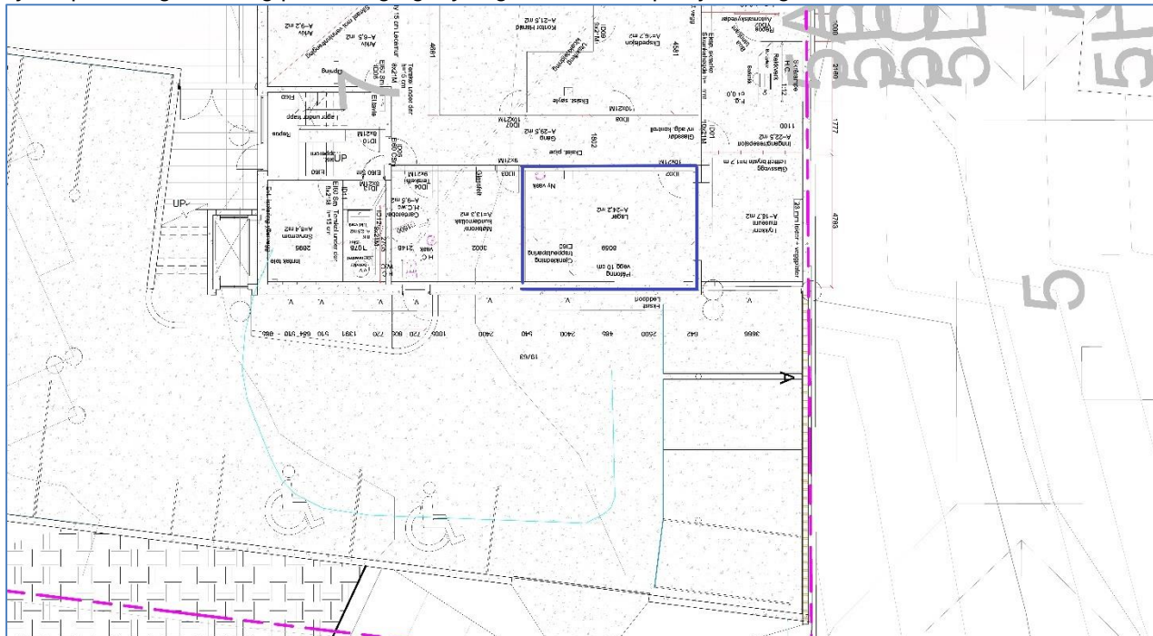
Figur 6.5.5 Areal til sykkelparkering i eksisterande bygning, om lag 25m 2 . (Storgata 7).
