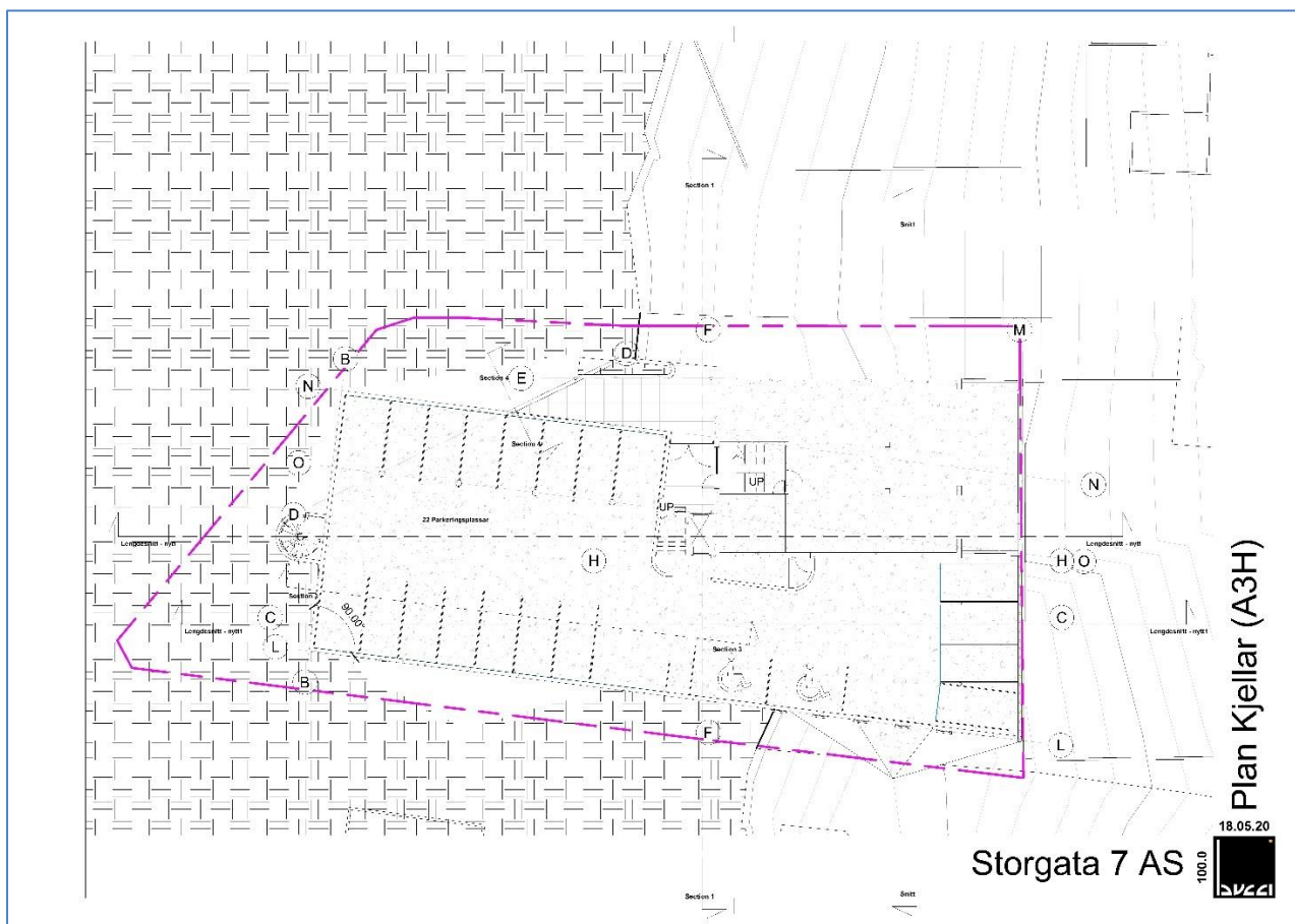
Figur 6.5.2 Oversikt over parkeringsplassar i parkeringskjellar. (22. stk.)
