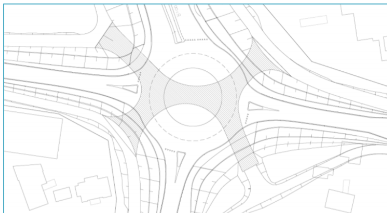
Figur. 15 Skisse som syner regulert løysing av bru for gåande og syklande over rundkøyring E39. Kjelde Planomtale områdeplan E39 Volda - Furene.
